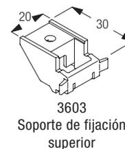
La placa de extensión se enrosca con tornillos 6748 (M4 x 8) para fijarla al soporte 3603.
