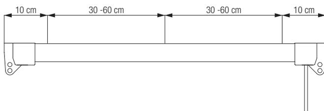
Las medidas indicadas son meramente indicativas y variarán en función del peso de la cortina. Para cortinas pesadas se recomienda que los puntos de fijación sean de máximo 300 mm.
