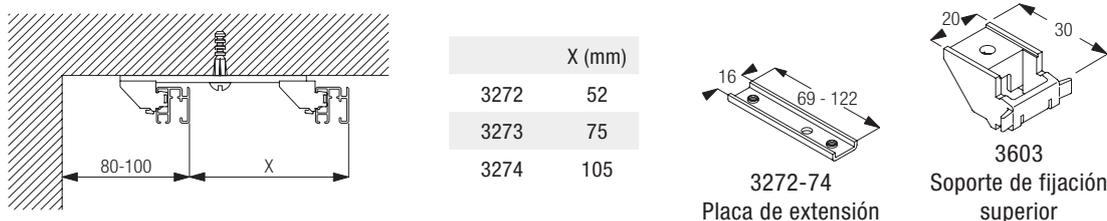
La placa de extensión se enrosca con 8 tornillos M4 para fijarla al soporte 3603.
